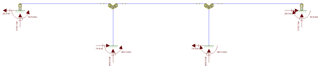
Figura 34 – Esforços devido ao carregamento dos trens-tipo + carga de distribuição na posição 4.
