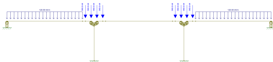
Figura 29 – Carregamento dos trens-tipo + carga de distribuição na posição 2.
