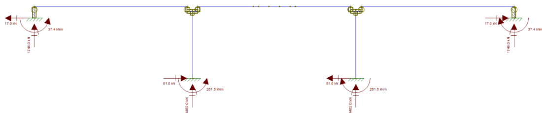
Figura 32 – Esforços devido ao carregamento dos trens-tipo + carga de distribuição na posição 3.
