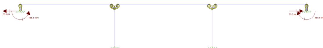
Figura 40 – Esforços devido à variação de temperatura de 55^{\circ}\text{C} .
