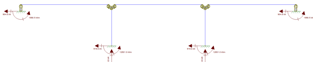
Figura 38 – Esforços devido ao carregamento de frenagem e aceleração.
