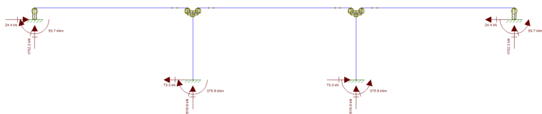
Figura 30 – Esforços devido ao carregamento dos trens-tipo + carga de distribuição na posição 2.
