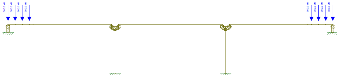
Figura 27 – Carregamento dos trens-tipo + carga de distribuição na posição 1.
